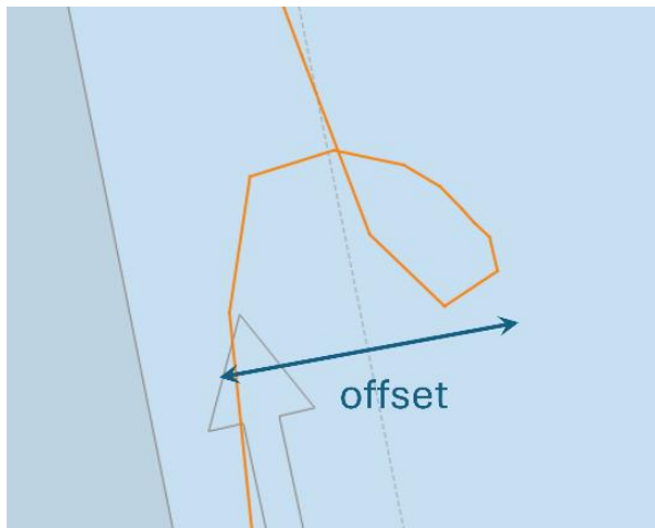
Figuur 4-7: Voorbeeld van de gemeten offset horende bij een rondtorn.
